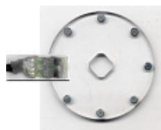
Tretsensor berührungslos erkennt vor- und rückwärts treten
